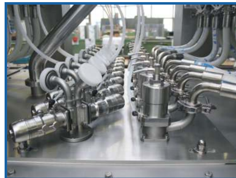
Unterschiedliche Fülldüsen (auch fest installiert) Different filling nozzles (also fix installed possible)
