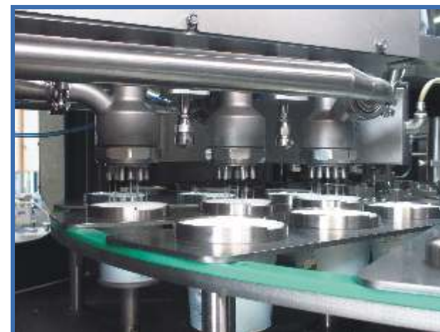
Unterschiedliche Fülldüsen wählbar (je nach Produkt) Different filling nozzles available (acc. to product)
