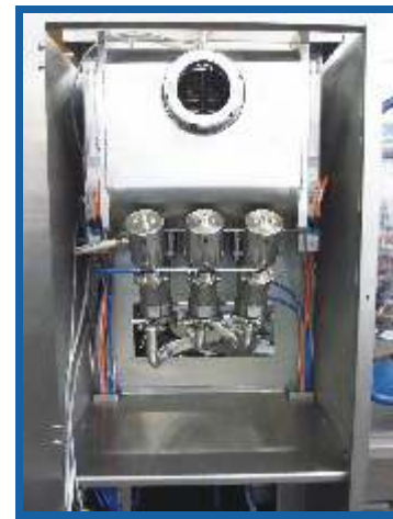
CIP / SIP-fähiger Doseur CIP / SIP-able filler
